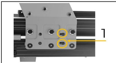
Nach längerem Gebrauch kann der Schraubenweg der Spindel anormal sein. Hierzu müssen Sie nur die seitliche Abdeckung der Maschine entfernen, beide Schrauben (1) lockern (→Feder kehrt in ursprüngliche Position zurück) und danach Schrauben wieder festziehen und Abdeckung wieder befestigen.
